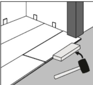
**Étape 1 :** Coupez suffisamment d'espace sous l'embrasure de la porte pour pouvoir y glisser la planche. Glissez la planche avec l'extrémité verrouillable vers l'extérieur. Tapez le côté long avec le marteau et la cale de frappe jusqu'à l'emboîtement des deux planches.
