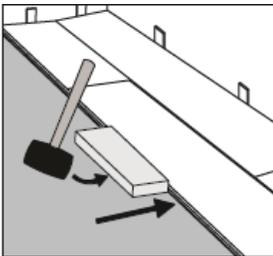
**Étape 5 :** **IMPORTANT!** Au besoin, utilisez un marteau et une cale de frappe pour taper sur le côté long de la planche afin de vous assurer que la fixation est serrée. **TOUT ÉCART PEUT COMPROMETTRE LE SYSTÈME DE VERROUILLAGE!**
