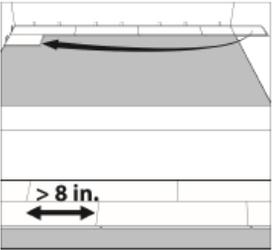
**Étape 3 :** Utilisez la planche coupée à la fin de la première rangée pour commencer la deuxième rangée. Il doit y avoir un écart d'au moins 8 po (20 cm) entre les joints d'extrémités des planches de la rangée adjacente.
