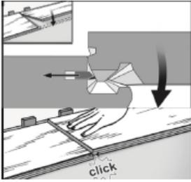
**Étape 2 :** Fixez les extrémités courtes des planches en insérant la languette dans la rainure en angle et en appuyant jusqu'à l'emboîtement. Répétez cette étape jusqu'à la fin de la première rangée.
