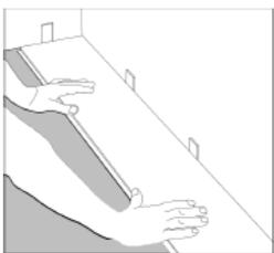
**Étape 1 : Effectuez l'installation de gauche à droite. Insérez des espaceurs aux extrémités et sur les côtés où les planches touchent au mur.**
