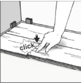
**Étape 4 :** Fixez les extrémités longues des planches en insérant la languette dans la rainure en angle et en appuyant jusqu'à l'emboîtement. Glissez la planche vers l'extrémité de la dernière planche installée jusqu'à ce que la languette touche légèrement la rainure.
